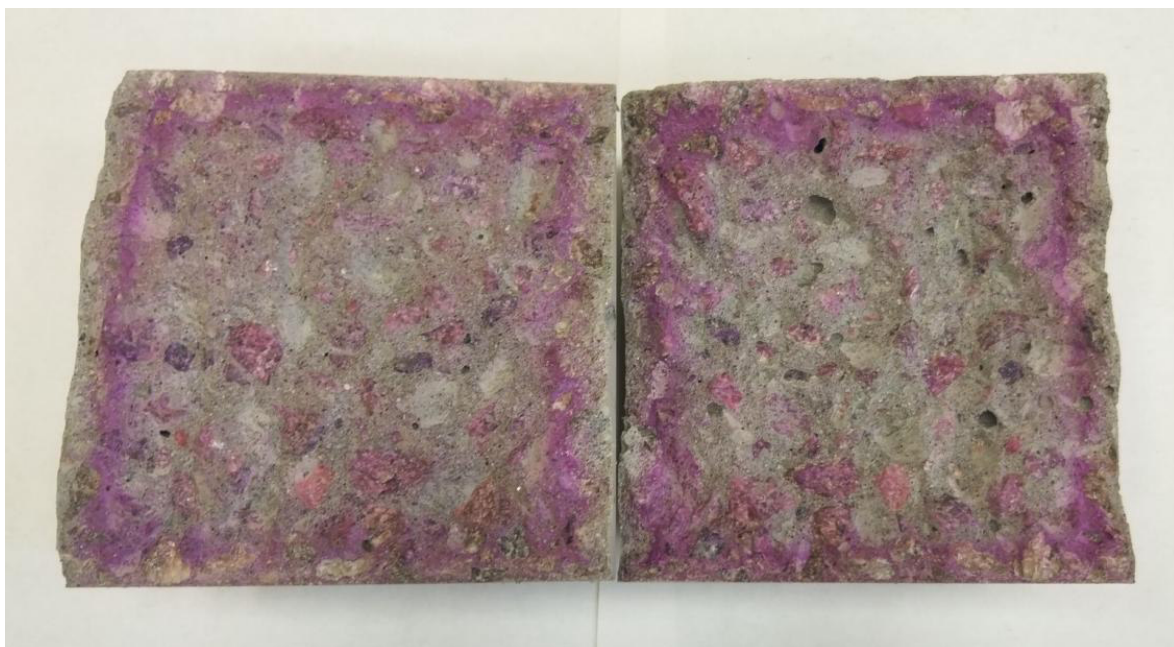
Рисунок 6 – Внешний вид контрольных бетонных образцов (без покрытия) после 14 суток испытаний
